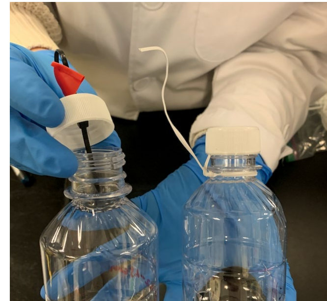
蓋子穿孔後塑紮帶穿孔固定或鋼絲繞圈固定
