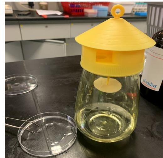
Step3: 加入100ml食鹽水和 15ml芥花籽油 懸掛在距離地面1.5m的位置
